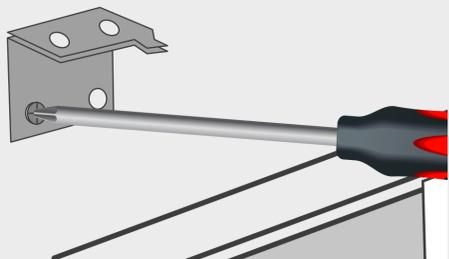
Posicione o suporte sobre a bucha aplicada e coloque o parafuso do seu kit parafusando-o com uma chave philips ou parafusadeira
