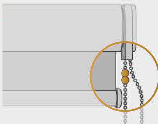
Para um ajuste de regulagem de altura mais fino, utilize a bola limitadora. Retire e coloque novamente a bola até chegar no ajuste desejado. A bola limitadora não deve ser regulada em um tamanho maior do que a altura da sua persiana.
